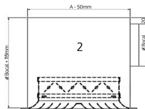
Caixa Plenum quadrada com acoplamento na ABA do difusor a caixa não é acoplada no difusor e acompanha cavalete central para fixação.
