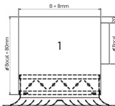
Caixa Plenum quadrada com acoplamento no colarinho do difusor a caixa é acoplada em fábrica e não acompanha cavalete central.
