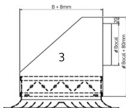
Caixa Plenum chanfrada com acoplamento no colarinho do difusor a caixa é acoplada em fábrica e não acompanha cavalete central.
