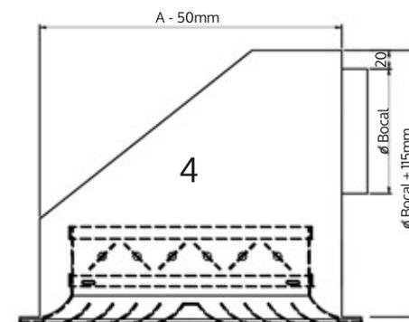
Caixa Plenum chanfrada com acoplamento na ABA do difusor a caixa não é acoplada no difusor e acompanha cavalete central para fixação.
