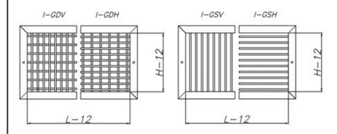
As dimensões podem ser de colarinho ou de aba-aba, quando não especificado será nominal, ou seja colarinho - 12mm.
